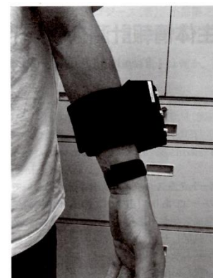
図2 開発したウェアラブル型 FGB センサシステム（手首に巻かれたリストバンドの内面に FGB センサの光ファイバが設置されている）
